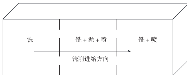
图1 试验分区及铣削进给方向
